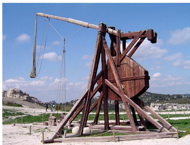
Abb. 26: Blide mit beweglichem Gegengewicht, Frankreich (Rekonstruktion) [3]
